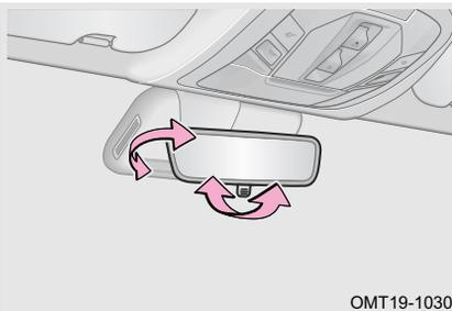
Перед началом движения отрегулируйте положение внутреннего зеркала заднего вида и убедитесь в том, что в результате этого обеспечивается оптимальный обзор пространства позади автомобиля.
