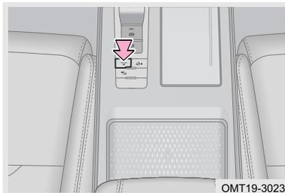
По умолчанию после пуска двигателя включен режим ECO. Нажатие переключателя режимов вождения позволяет последовательно переключать режимы SPORT и ECO. Выбирайте режим, наиболее подходящий для текущих условий эксплуатации автомобиля.
