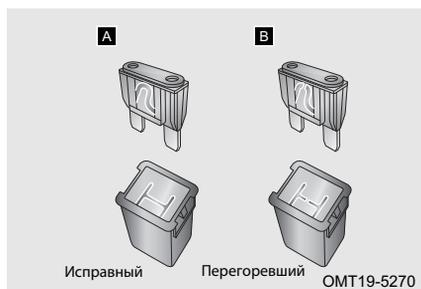
**A** Исправный предохранитель.
