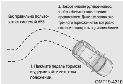
Антиблокировочная тормозная система (ABS) вступает в действие только при опасности блокировки колес при торможении, но не во время нормального торможения. Если во время торможения педаль тормоза пульсирует и слышен шум, это указывает на работу системы ABS. Такие пульсации и шум являются нормальным явлением. Не отпускайте педаль тормоза.
