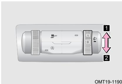
Переключатель корректора фар имеет 4 положения (0, 1, 2 и 3), которые следует выбирать в зависимости от количества пассажиров и багажа в автомобиле.
