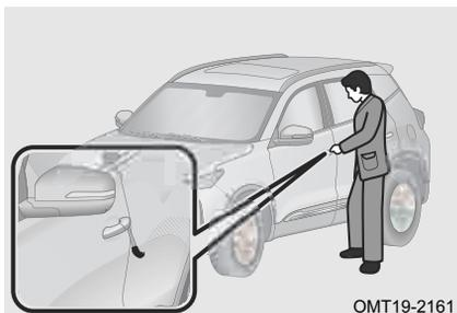
Шаг 1. Вставьте механический ключ в отверстие под заглушкой в наружной ручке двери водителя. Действуя ключом как рычагом, откройте заглушку.
