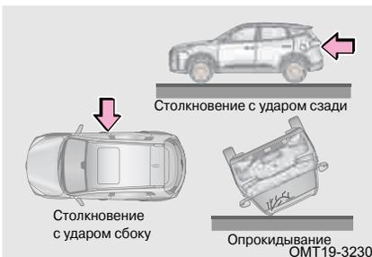
Как правило, подушки безопасности водителя и переднего пассажира не срабатывают при столкновении с ударом сзади или сбоку, при опрокидывании автомобиля и при фронтальном столкновении на малой скорости.
