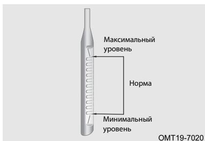
Положите ветошь под конец щупа, чтобы масло не капнуло на двигатель или кузов автомобиля.
