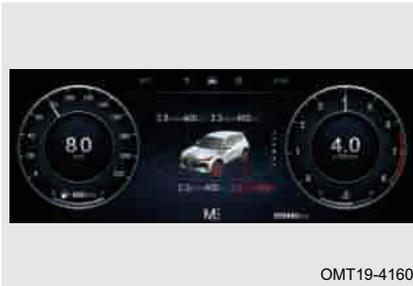
Переключиться на экран системы контроля давления воздуха в шинах можно нажатием кнопки "◀" или "▶" на рулевом колесе.
