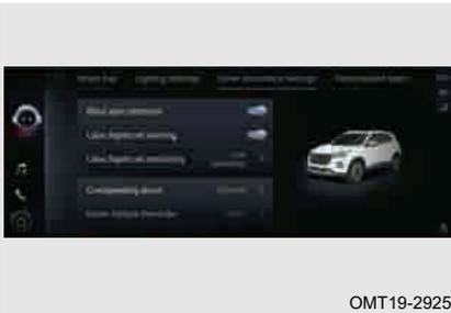
[Blind spot detection system] (Система контроля «мертвых» зон): ON (Включено)/OFF (Выключено).
