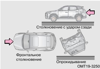
Боковые подушки безопасности, оконные шторки безопасности и передняя центральная подушка безопасности (для некоторых вариантов исполнения автомобиля) могут не сработать при фронтальном столкновении или столкновении с ударом сзади, при опрокидывании автомобиля или при столкновении с ударом сбоку на малой скорости.
