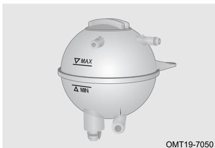
На холодном двигателе уровень охлаждающей жидкости должен находиться между метками MIN и MAX. Если уровень охлаждающей жидкости опустился до отметки MIN или ниже ее, долейте охлаждающую жидкость в бачок и незамедлительно обратитесь на сервисную станцию официального дилера для проверки и ремонта автомобиля.
